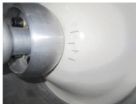
图 2 绝缘子表面固定金属微粒模型
